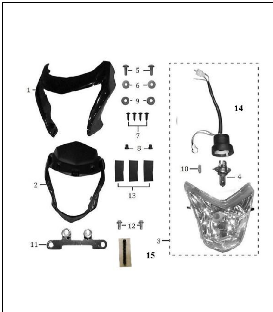
FIGURA N° 32: FAROLA - CARENAGE FAROLA
