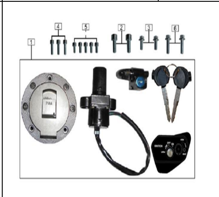
FIG. Nº 35 SWICHE DE ENCENDIDO
