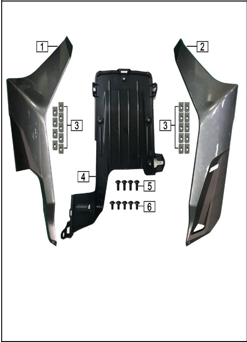
FIGURA N° 38: TAPA PISO LATERALES
