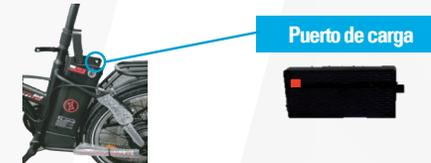
b- Una vez finalizada la carga, cuando la luz led del cargador pase al color verde, esto significa que la carga está en ciento por ciento (100%). Debe desconectar primero el cable del cargador del toma corriente de 110 V / 60 Hz, y luego desconecte el cable de la fuente de alimentación de carga de la bicicleta T-FLEX.
