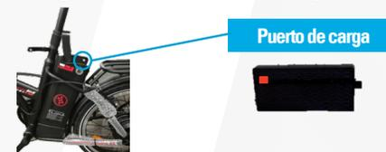
b- Una vez finalizada la carga, cuando la luz led del cargador pase al color verde, esto significa que la carga está en ciento por ciento (100%). Debe desconectar primero el cable del cargador del toma corriente de 110 V / 60 Hz, y luego desconecte el cable de la fuente de alimentación de carga de la bicicleta T-FLEX PRO.
