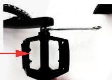
Montar pedal RH Y LH y ajustarlo con la llave #15
