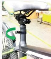
Asegurar el sillín con la palanca de sujeción como indica la imagen
