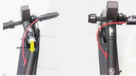
**b-** Debe posicionar la Patineta Eléctrica LITE en el gato lateral ubicado al lado izquierdo de la parte inferior de la Patineta Eléctrica LITE.
