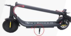
**c-** Debe extender el vástago hasta llegar al punto de acople y ajustarlo con la palanca.
