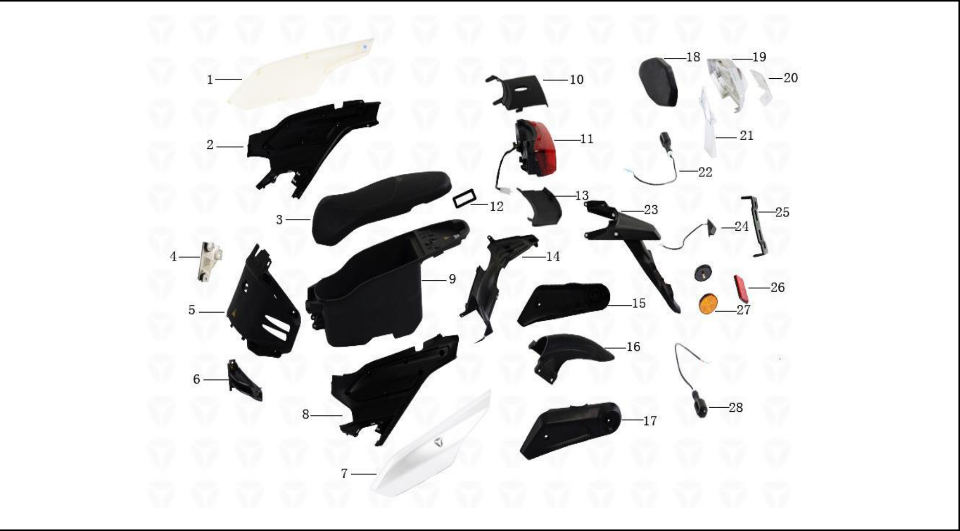
FIGURA N° 5: CUBIERTAS - CAJA GUANTERA - STOP
