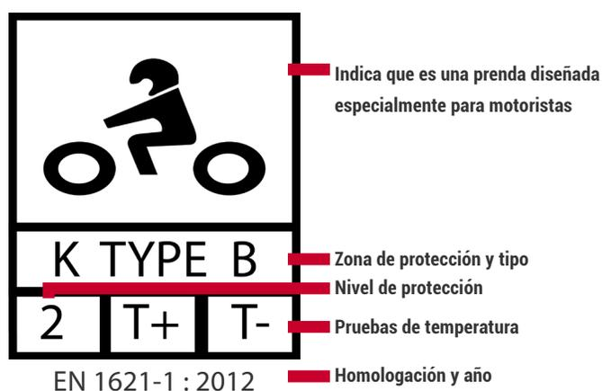
Alrededor de la parte inferior del cuadro, encontraremos las letras (EN) seguidas de una serie de números que proporcionan información relevante sobre el elemento de seguridad. La primera sección de números, ubicada después de EN, indica la normativa específica. Luego, nos detalla para qué zona del cuerpo está destinada la protección y si corresponde a botas, guantes, rodilleras, entre otros.
