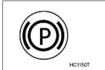
Cuando el conductor tira hacia atrás de la manija del freno de estacionamiento hasta la posición de bloqueo, esta luz indicadora se enciende para recordarle al conductor que el vehículo está frenado. Cuando se tira de la manija del freno de estacionamiento hacia arriba a la posición de liberación, esta lámpara indicadora se apaga. Asegúrese de que esta luz indicadora esté apagada antes de poner en marcha el vehículo
