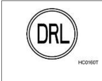
Cuando la lámpara de funcionamiento diurno está funcionando, la lámpara indicadora de funcionamiento diurno se enciende. Condición de encendido de la lámpara de funcionamiento diurno: La velocidad del motor es superior a 400 rpm o la señal de control de la lámpara de funcionamiento diurno es efectiva.
