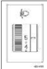
El haz de los faros puede cambiar cuando la carga del vehículo ha cambiado o la condición horizontal de la cabina ha cambiado; por lo tanto, es necesario cambiar el haz de luz baja del faro para una correcta irradiación.
