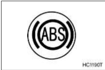
Esta lámpara indicadora funciona para indicar el estado de funcionamiento del ABS. Cuando se enciende el interruptor de la llave para el auto chequeo del vehículo, la lámpara indicadora del ABS se enciende y luego se apaga. Si esta lámpara no parpadea o no se apaga en varios segundos después del arranque del motor, indica que el ABS está funcionando mal.
