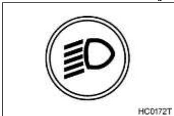
Cuando el mango del interruptor combinado izquierdo está en la posición de luz baja, esta lámpara indicadora se enciende.
