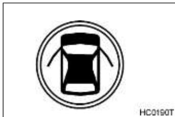
Esta luz indicadora funciona para indicar el estado de todas las puertas del vehículo. Si alguna puerta no está cerrada o no está correctamente cerrada, la lámpara indicadora de la puerta correspondiente se enciende para recordar al conductor que la puerta correspondiente no está correctamente cerrada. La luz indicadora correspondiente se apaga después de que la puerta se cierra correctamente.
