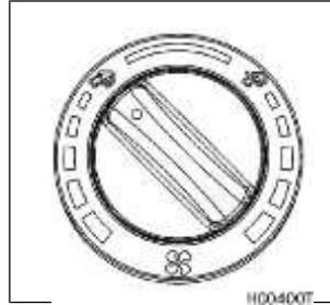
Modo de recirculación interna: El ventilador está apagado y el sistema de aire acondicionado y calefacción está en modo de recirculación interna de aire.
