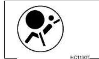
para indicar el estado de funcionamiento de la bolsa de aire. Cuando se enciende el interruptor de la llave para iniciar el auto chequeo del vehículo, esta lámpara indicadora se enciende automáticamente durante varios segundos y luego se apaga. Si esta lámpara se mantiene encendida, la bolsa de aire tiene problemas.
