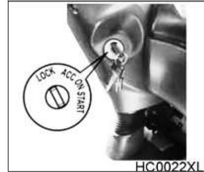
1. LOCK (Bloqueo): La llave puede ser insertada y retirada sólo en la posición LOCK.
