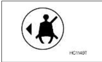
Si el cinturón de seguridad del conductor no está abrochado, esta lámpara indicadora se enciende para recordarle al conductor que debe abrocharse el cinturón de seguridad.
