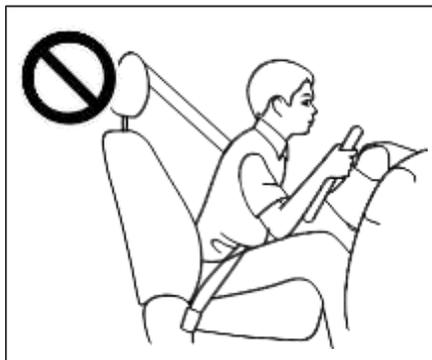
Para reducir la probabilidad de heridas en caso de accidente y maximizar la protección del sistema, todos los pasajeros del vehículo deben permanecer sentados y el asiento debe estar en posición vertical. Viajar con el asiento en posición inclinada puede causar que el cinturón no funcione de manera apropiada.
