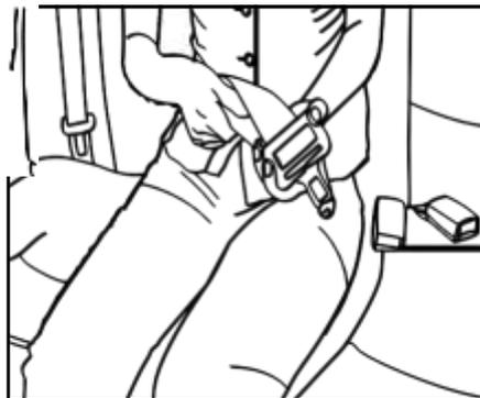
Al ajustar la longitud del cinturón, mantén la hebilla en un ángulo con el cinturón y tira del cinturón hasta la longitud deseada. Presionar la hebilla de metal facilita el ajuste.
