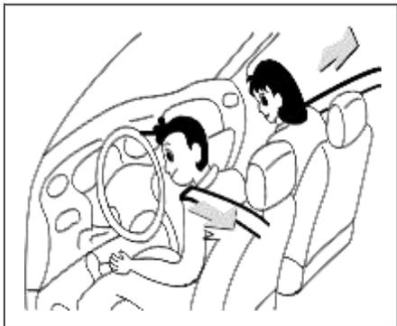
Algunos modelos están equipados con dispositivos de pretensión de cinturón en los asientos de conductor y copiloto. Este dispositivo asegura la protección de los pasajeros en caso de choque delantero. El dispositivo funciona con la bolsa de aire al mismo tiempo. Cuando el vehículo se detiene o el pasajero se inclina rápidamente, el retractor será bloqueado. En ciertos tipos de choques delanteros, el dispositivo opera para tensar el cinturón y amortiguar el impacto del pasajero.
