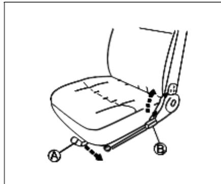
Para desbloquear el asiento debes tirar de la palanca y mantenerla por debajo del asiento. Desliza el asiento a la posición deseada y libera la palanca. Intenta mover el asiento de adelante hacia atrás para confirmar que el asiento está bloqueado y fijo.
