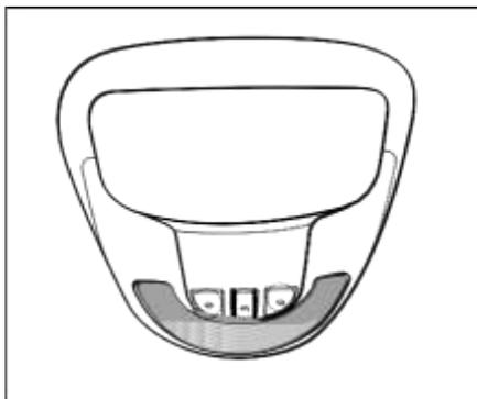
**PUERTA:** En este modo, la luz de domo delantera se enciende al abrir una puerta y se apaga si permanece abierta por más de 30 minutos. Cuando el interruptor está en posición LOCK/ ACC, cierra la puerta y la luz se apaga después de 6 segundos. Cuando el interruptor está posición ON, la luz se apaga al cerrar la puerta.
